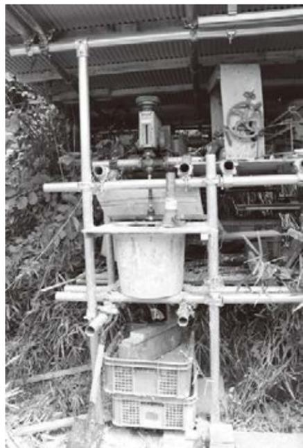
【工夫例】新聞の薪を作る装置。ガラス製品の梱包資材などとして使用し終わった古新聞や段ボールに水を含ませ、かき混ぜて粘土状になったものを圧縮する。作業炉の熱気を利用して完成。ぬれた新聞のかたまりは乾きにくい、窯のある環境を活用。
