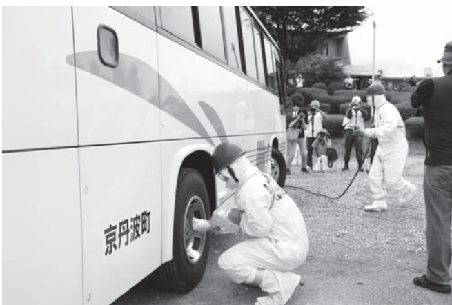
↑スクリーニング検査 放射能の付着の有無を検査。
