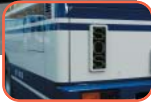
車両後部の非常表示灯
