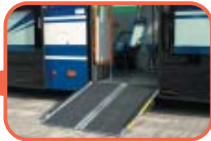
高齢者や障害のある人に配慮したスロープ付き
