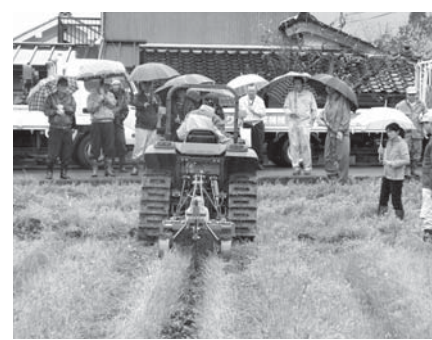
弾丸による暗きよ排水の実演作業を見学する参加者(市場区内のほ場)
