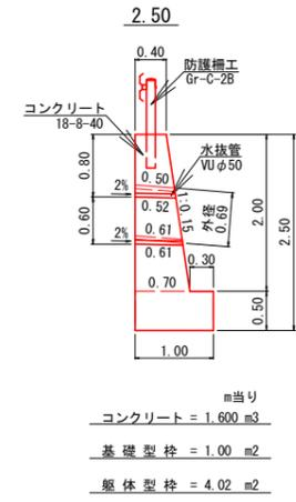
管渠工縦断面図 S=1:100
