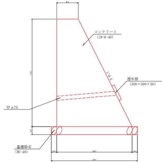
※水抜きパイプ (VP φ75) は2.5m2に1箇所設けること
