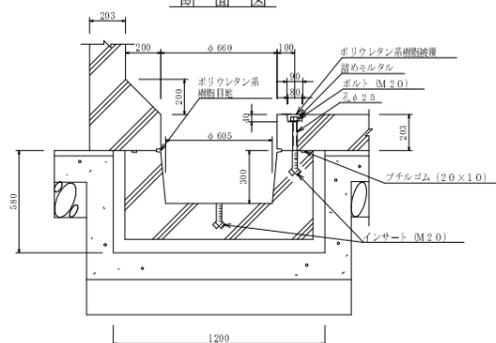
吸管投入口 S=1:20 断面図
