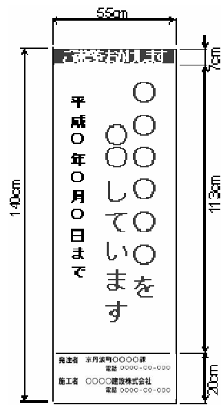
[工事説明看板]
