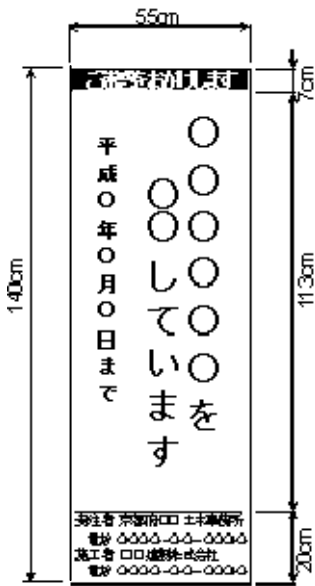
[工事説明看板]
