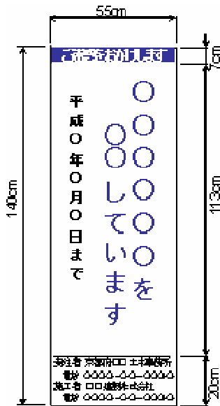
[工事説明看板]
