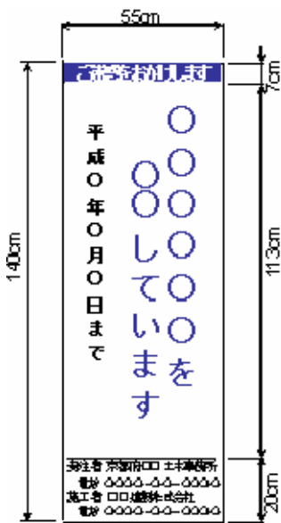
[工事説明看板]
