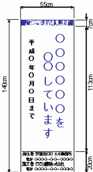
[工事説明看板]
