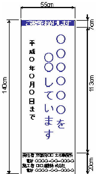
[工事説明看板]
