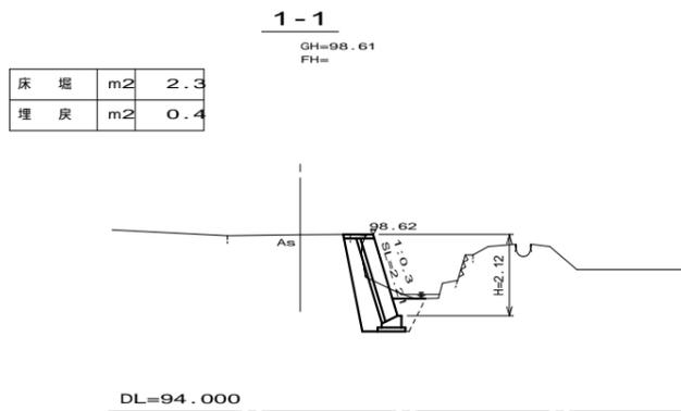
コンクリートブロック積工断面図 S=1:50
