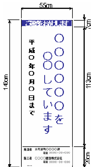
[工事説明看板]
