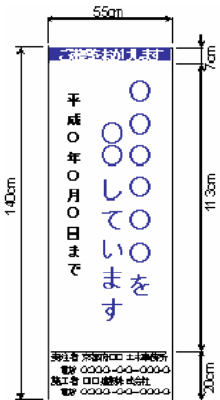
[工事説明看板]
