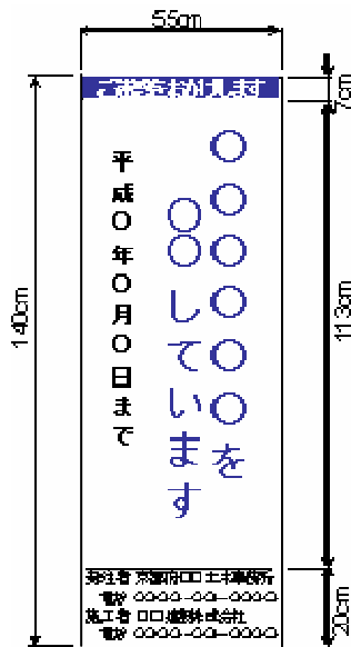
[工事説明看板]
