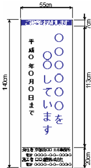
[工事説明看板]
