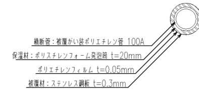
防凍工 詳細図 S=1:10
