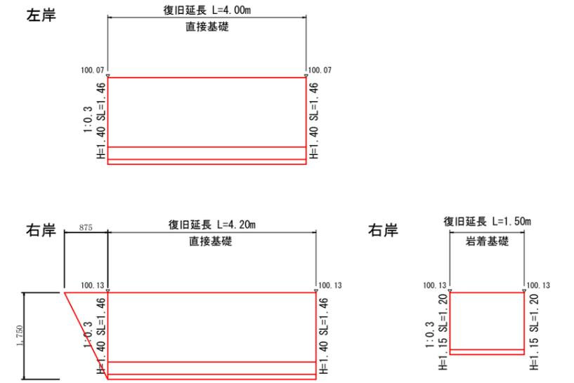
コンクリートブロック積工断面図 S=1:50
