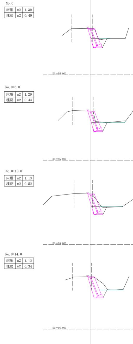
ブロック積工断面図 S=1:50
