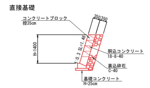
コンクリートブロック積工断面図 S=1:20
