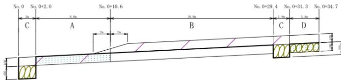
新設コンクリート 展開図 H=1:200 V=1:50
