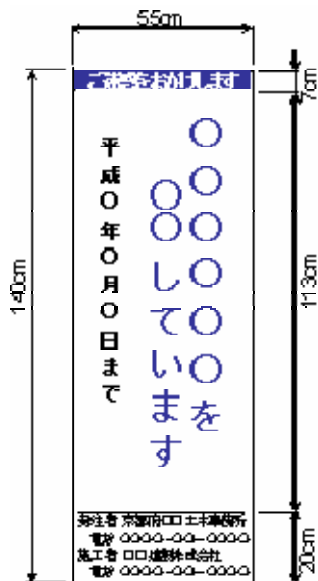
[工事説明看板]
