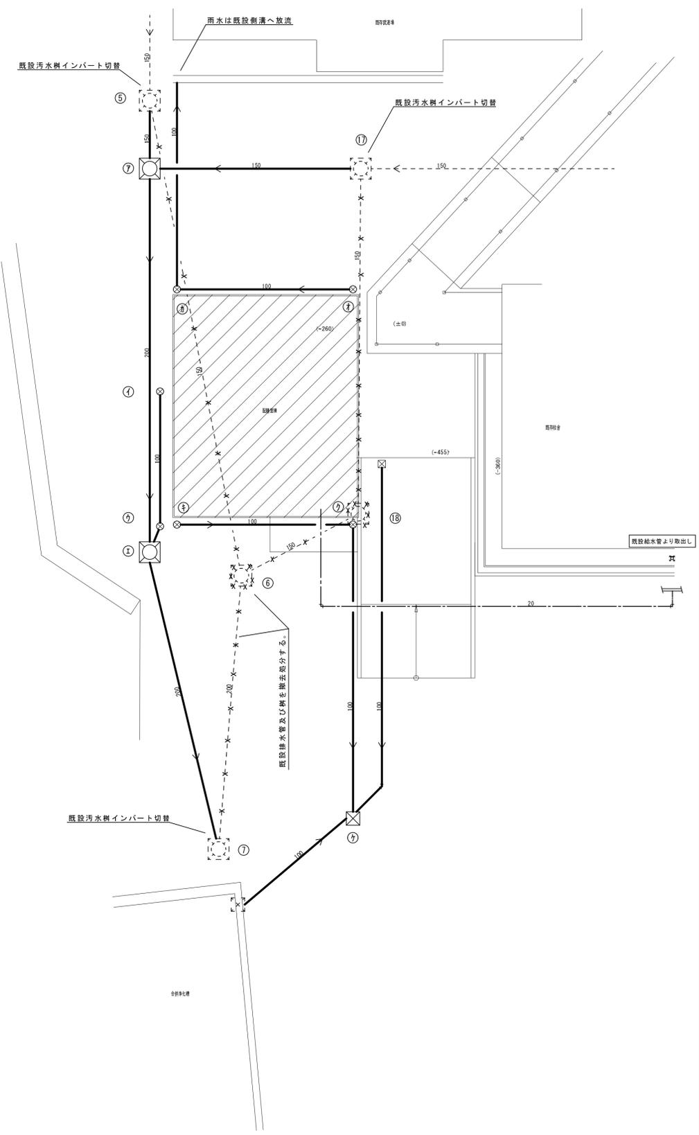
※ 図中範囲で既設給水管及び消火管の埋設配管を撤去処分の上、新設する。
