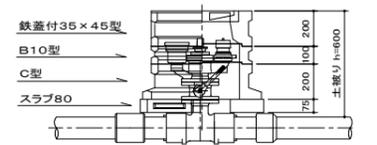
**仮設給水管布設標準図**
