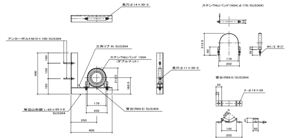
注・支持金具は橋梁地盤にアンカーボルト・ナットでしっかり固定して下さい。
