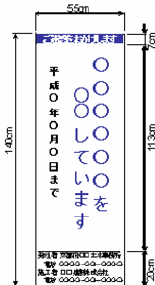
[工事説明看板]
