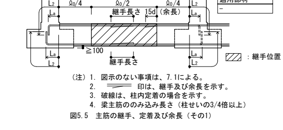
図5.5 主筋の継手、定着及び余長(その1)
