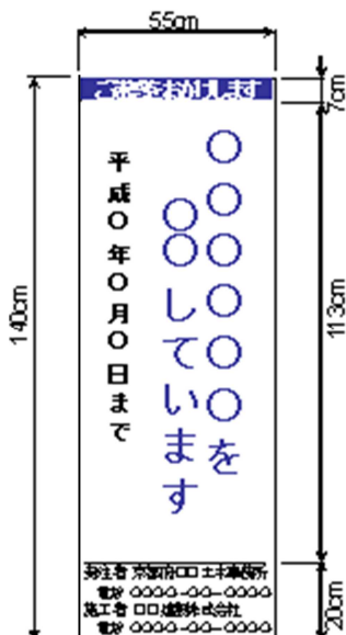
[工事説明看板]
