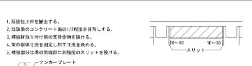
6-2 あばら筋補強溶接金網補強
